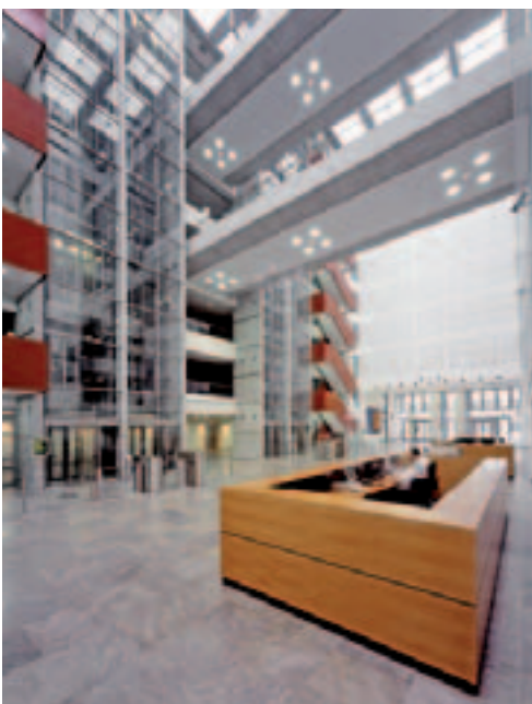
IBC Händlerzentrum Deutsche Bank: In der stark frequentierten Eingangshalle setzt der großformatige, farblich sortierte Bodenbelag aus Kirchheimer Muschelkalk optische Akzente. Die Oberflächen sind C120 geschliffen.
